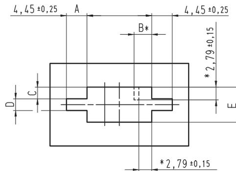
Blechdicke/Thickness = min. 0,8 mm
